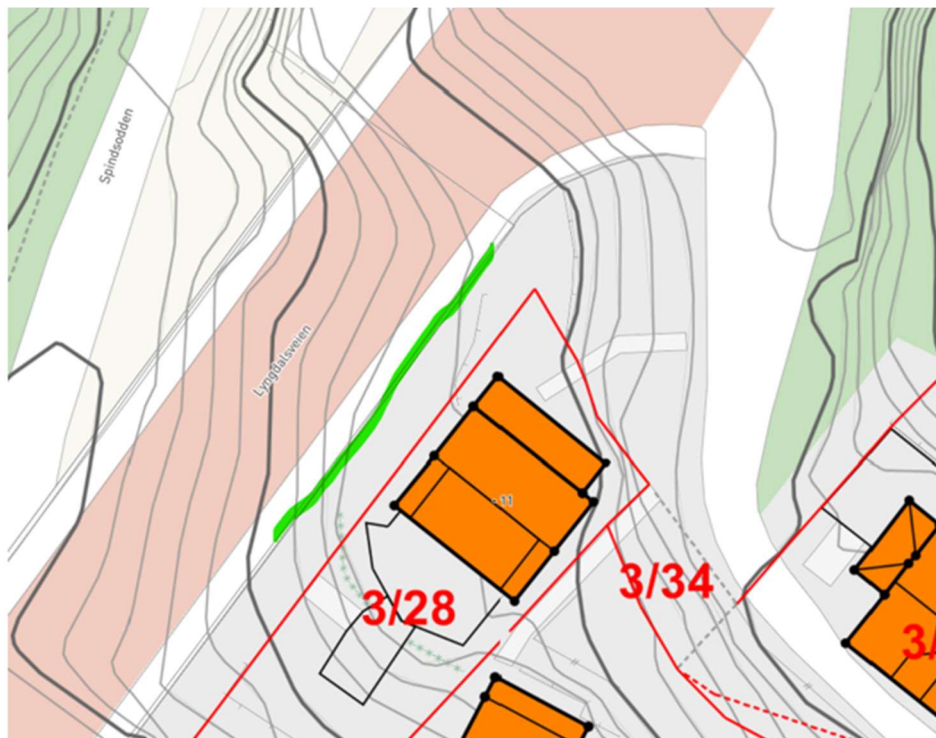
Behov for platekledning av laminatglass mot bolighus
